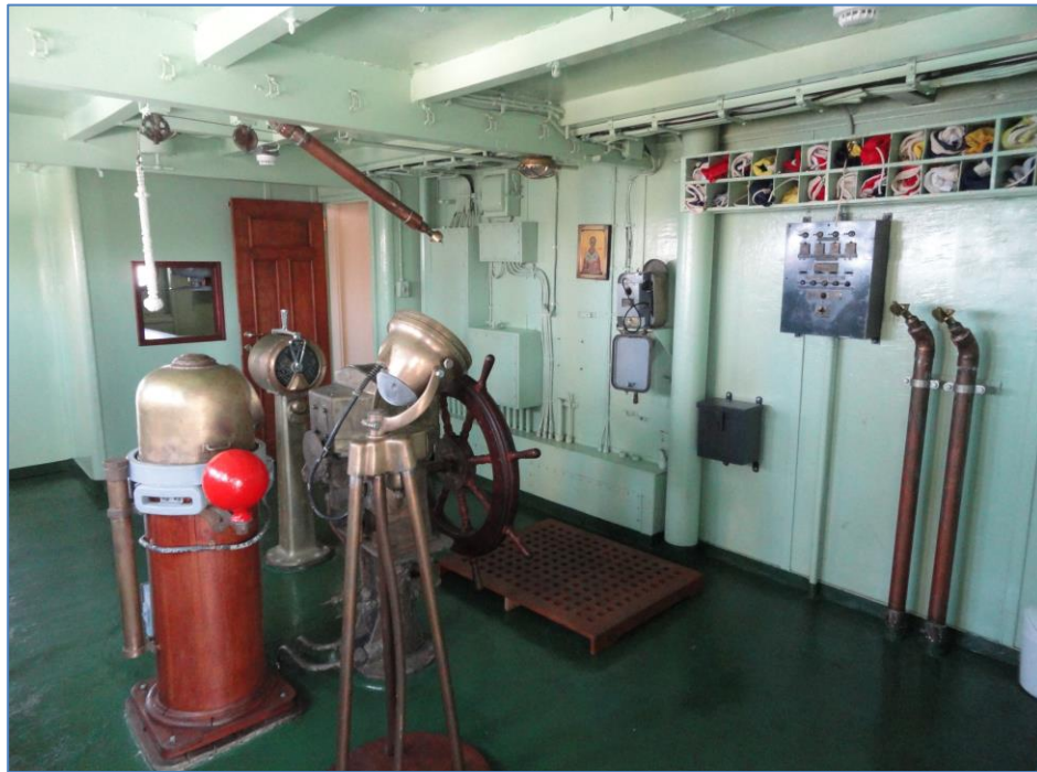
Stuurhuis met Telegraaf, Kompas en twee spreekbuizen (naar de MK) rechtsachter
