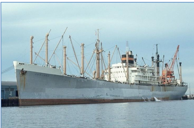
Bouwjaar: 1946/1947 als type C3-S-A5 in Chester-Panama, USA. Afmetingen: 150,06 x 21,23 x 8,86 mtr. Passagiersaccommodatie: 12 Voortstuwing: Hp en Lp General Electric steam turbine en Waterpijpketel, 8500 pk / 16,5 kn
