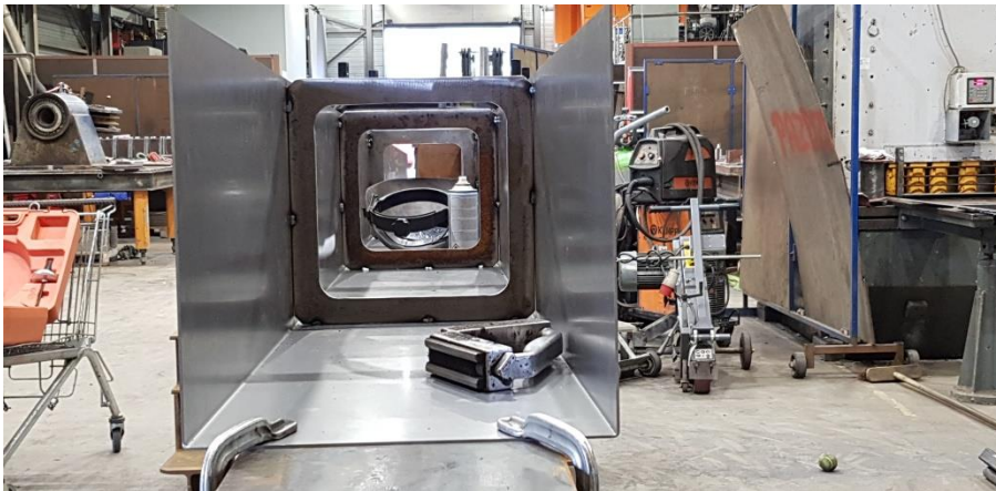
Verstevigingschotten worden met een hechtglas aan de binnenzijde van de mast vast gezet.
