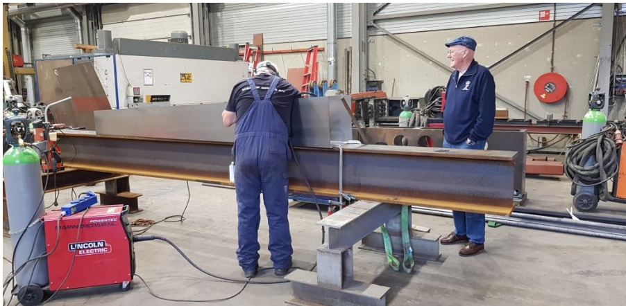
Eerste deel (3 m lengte ) van de KRL mast
