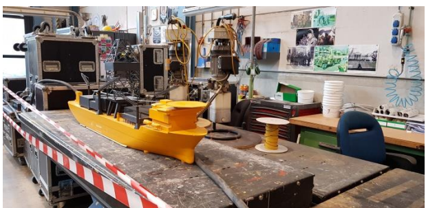
9. Diepwatertank. Deze tank wordt gebruikt voor weerstands- en voortstuwingsonderzoek, dus zonder golven en stroom. Tevens is aan de wand van het bassin het aantal door MARIN geteste schepsschroeven te zien.
