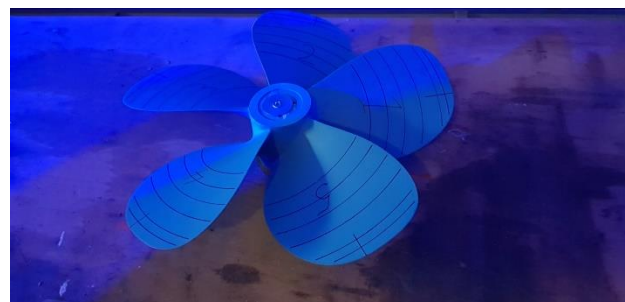
4. Cavitatietunnel. Water stroomt in de tunnel met een snelheid van 2 m/s. Schroeftoerental is 20 omwentelingen per minuut. Door gebruik te maken van een stroboscoop met de zelfde frequentie als het schroeftoerental, lijkt deze stil te staan.
