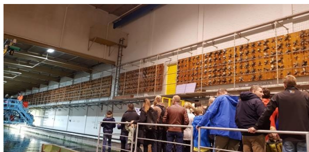
9. Diepwatertank. Deze tank wordt gebruikt voor weerstands- en voortstuwingsonderzoek, dus zonder golven en stroom. Tevens is aan de wand van het bassin het aantal door MARIN geteste schepsschroeven te zien.
