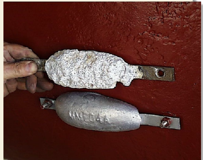
Een door corrosie aangevreten anode en een nieuwe zinkanode.
