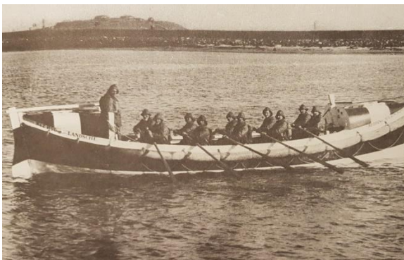
Zelf richtende Roei Reddingsboot van het type : Beeching-Peake
