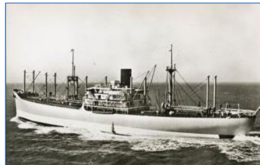
ss. Drente (C 3 -S-A 5 ), 8500 pk turbine van Allis Chalmers Mfg, 16,5 kn
