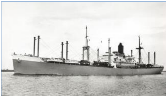
ss. Friesland (C 3 -S-A 5 ), 8500 pk turbine van Allis Chalmers Mfg, 16,5 kn
