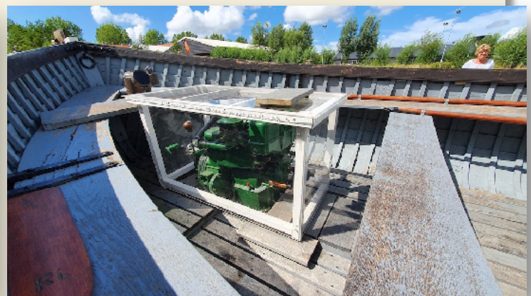
Door de weersinvloeden is het hout verweerd en zelfs gescheurd. Het enige positieve is dat de dieselmotor in een 'glazen huisje' is gezet.
